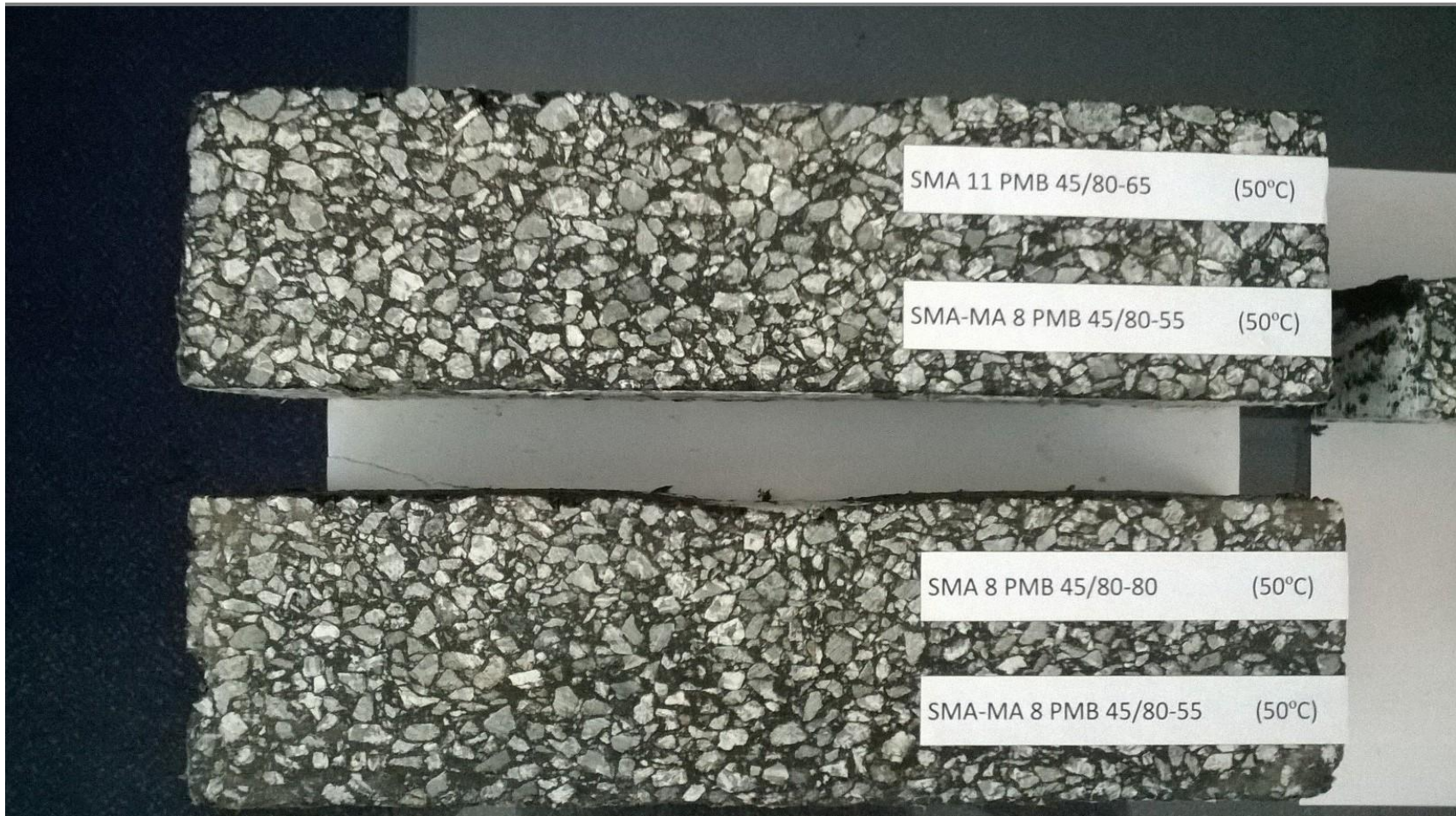
Rys. 9. Próbkki mieszanek mineralno-asfaltowych (warstwa ścieralna z SMA 11 i warstwa ochronna z SMA 8) po badaniu koleinowania
