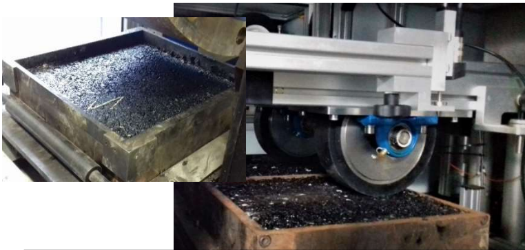
Próbka po zagęszczeniu i w trakcie badania
