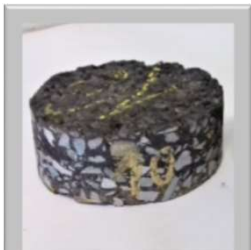
Rdzeń z nawierzchni
