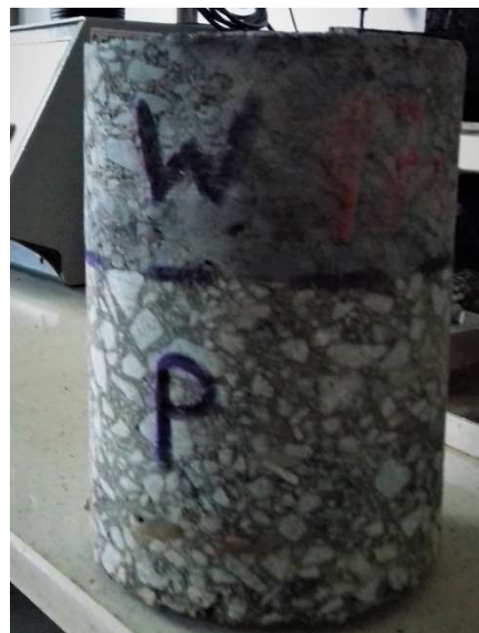
Rdzeń Ø 150 Warstwa wiążąca i podbudowy
