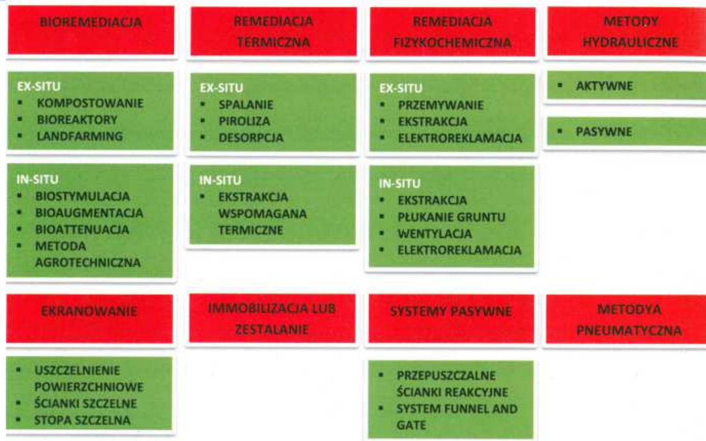
Rys. 17. Klasyfikacja metod rekultywacji gleb [opracowanie własne na podstawie Bilitewski i in. 2006 oraz http://chemia.nowa.ug.edu.pl/sites/default/files/_nodes/strona-chemia/14333/files/okladka_skrypt2014_inzynieria_srodowiska.pdf ]
