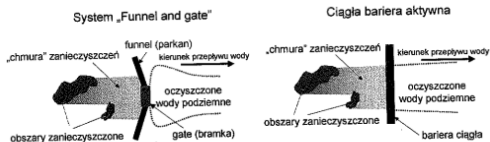
Rys. 4.6. Podstawowe systemy przepuszczalnych barier aktywnych (PRB) (USEPA, 1998)
